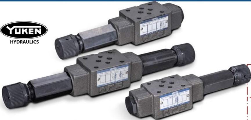
Dieses Ventil wurde speziell für die Anwendung in Anlagen mit starken Temperaturgefällen entwickelt. Das Ventil hält den Volumenstrom in den Arbeitsleitungen unabhängig vom Lastdruck, Eingangsvolumenstrom und der Viskosität konstant.
