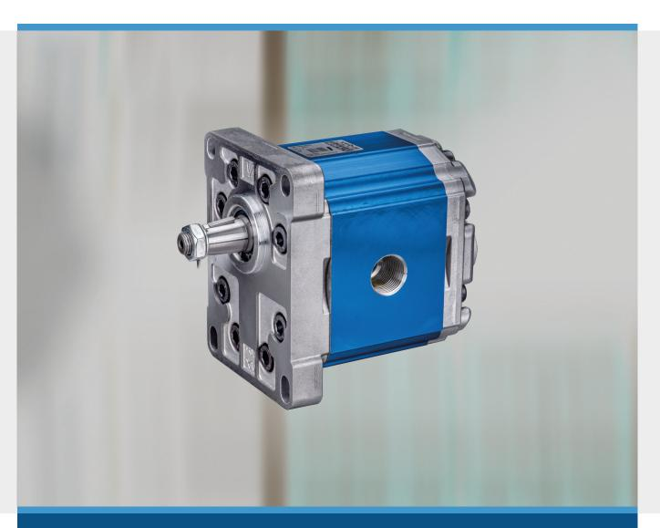
Frontflansch: 128,1mm x 98,4mm Einpass: Ø 50,8mm Welle: konisch 1:8 Ölanschlüsse: Innengewinde
