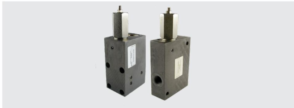
HYDAC Speicherladeventile regeln, innerhalb eines einstellbaren Schaltbereichs, die Ladung des Hydro-Speichers. Durch die Kombination mit einem Hydro-Speichers können Pumpen und Motoren an ölhydraulischen Anlagen mit schwankendem Volumenstrombedarf kleiner dimensioniert werden. Dies spart Kosten und Energie - eine unnötige Wärmeentwicklung wird somit vermieden.
