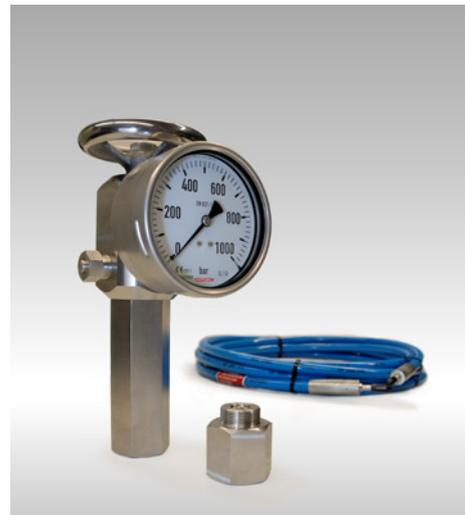
Die FPU-2 wurde speziell für Hochdruckanwendungen entwickelt. Ebenso, wie die FPU-1, ist die FPU-2 universell einsetzbar. Zum Füllen und/oder Prüfen von HYDAC Kolben- und Membranspeichern kann sie direkt aufgeschraubt werden. In Verbindung mit einem HYDAC Blasenspeicher ist der Hochdruckadapter A3H zu verwenden. Dieser ist standardmäßig nicht im Lieferumfang enthalten.
