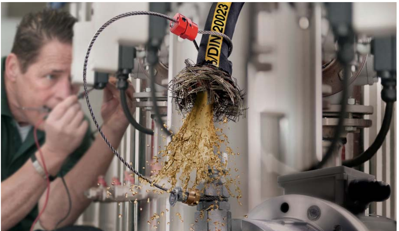
Cablelock®-Berstsimulation eines reißenen Hydraulikschlauches.
